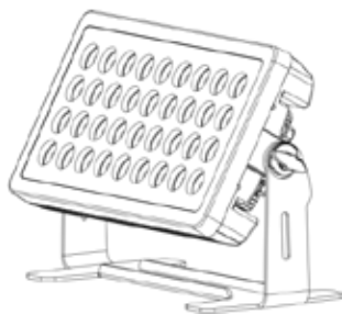
Montage au Sol
