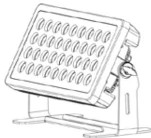
Montaje en el Suelo
